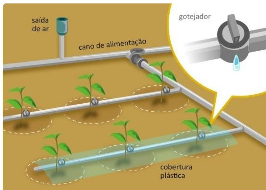
Figura 2.1: Esquema de um sistema de irrigação localizada, Fonte: ALMEIDA, FREIRE e CRUZ<sup>2</sup>
