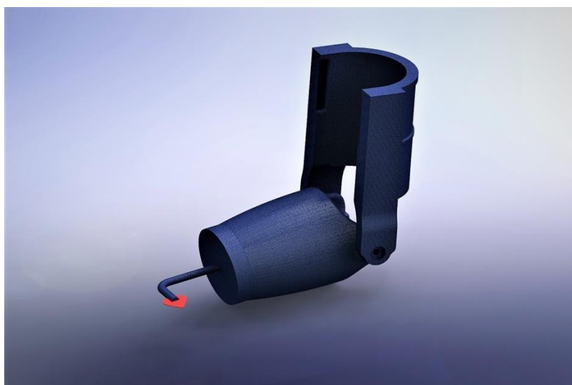
Figura 23 - Desenho renderizado prótese montada com ferramenta de palheta (Própria Autoria)
