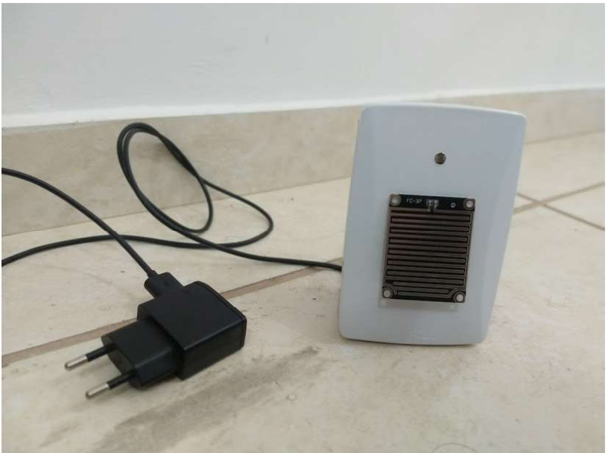
Figura 4.8: Case do módulo de sensoriamento do sistema.
