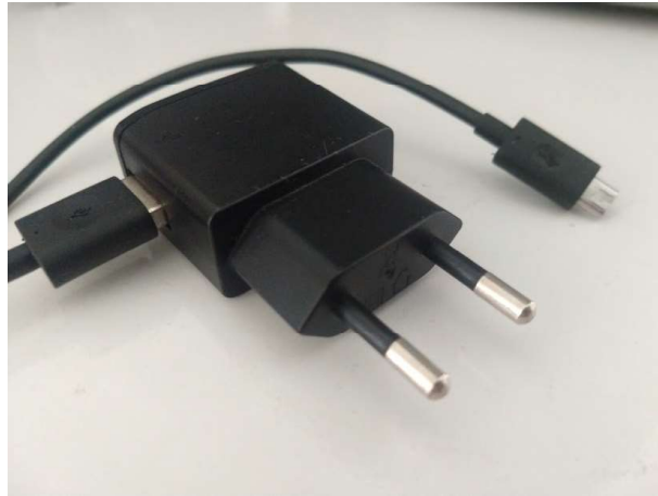
Figura 3.3: Fonte com conector micro USB.
