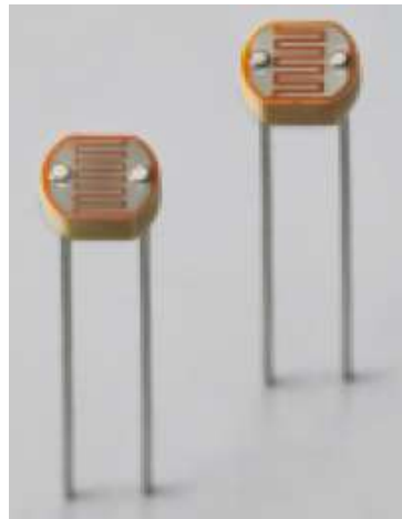
Figura 2.11: Sensor LDR. Fonte: [30]
