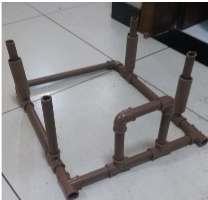
Figura 4.17: Construção da Plataforma que recebe a força Fonte: Próprio autor
