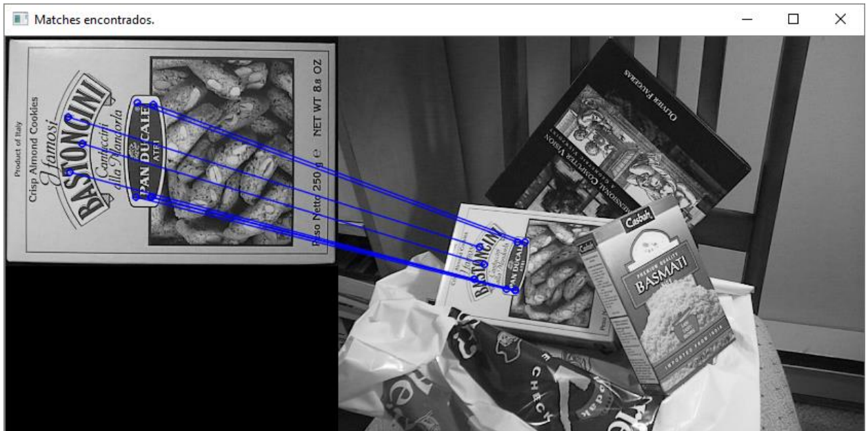
Figura 6.10 - Matches encontrados entre as imagens (utilizando homografia). Fonte: elaborado pelo autor.
