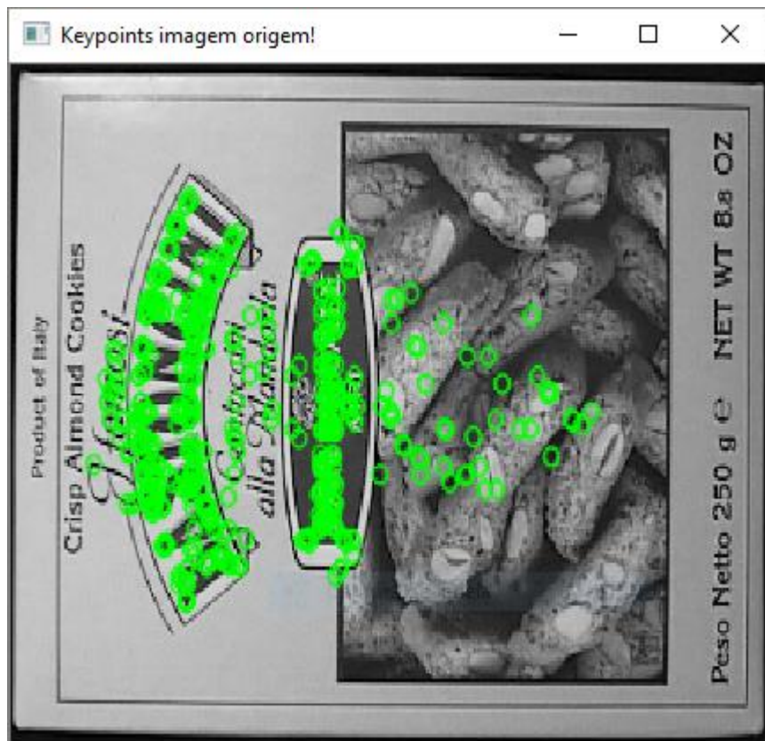
Figura 6.7 - Keypoints da imagem de origem (train image). Fonte: elaborado pelo autor.
