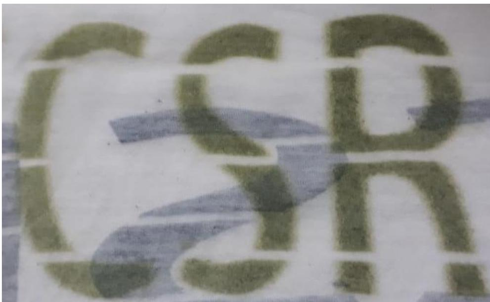
Figura 4.11d – Tecido de algodão estampado por silk digital, pela máquina projetada, após a quinta lavagem.
