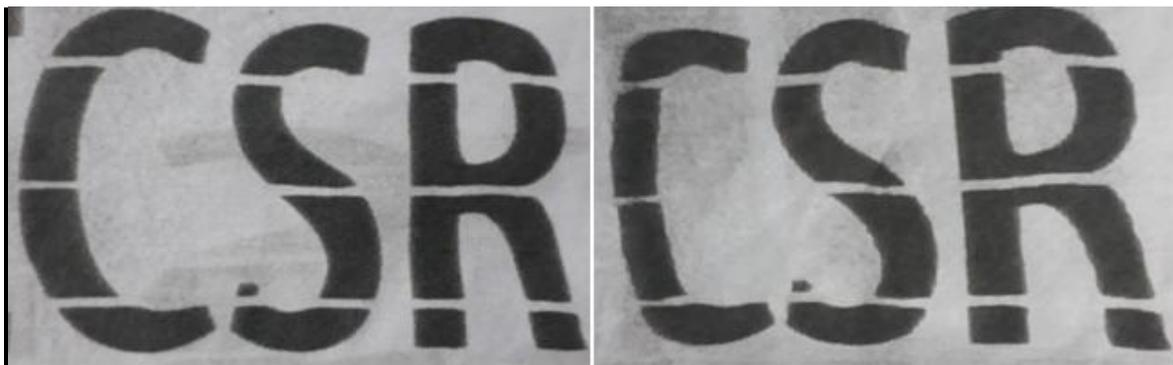
Figura 4.7 - Estampa realizada com ajuste em *software* RIP (à esquerda) e estampa realizada sem ajuste de qualidade (à direita).
