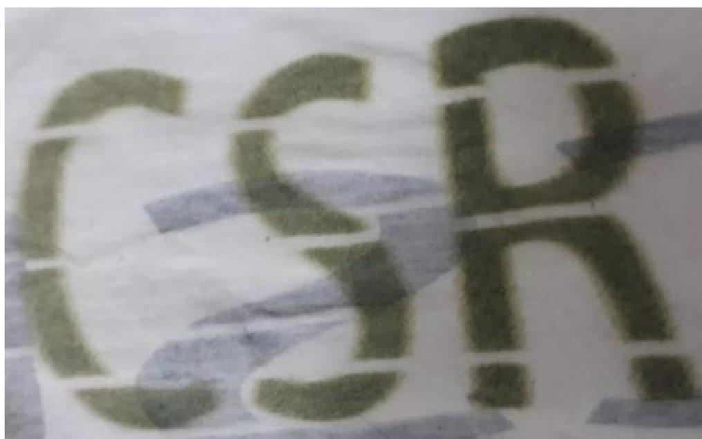
Figura 4.11c – Tecido de algodão estampado por *silk* digital, pela máquina projetada, após a terceira lavagem.
