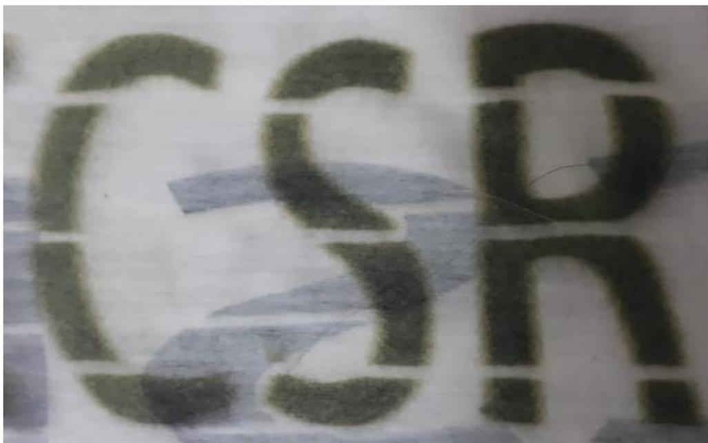
Figura 4.11b – Tecido de algodão estampado por *silk* digital, pela máquina projetada, após a primeira lavagem.
