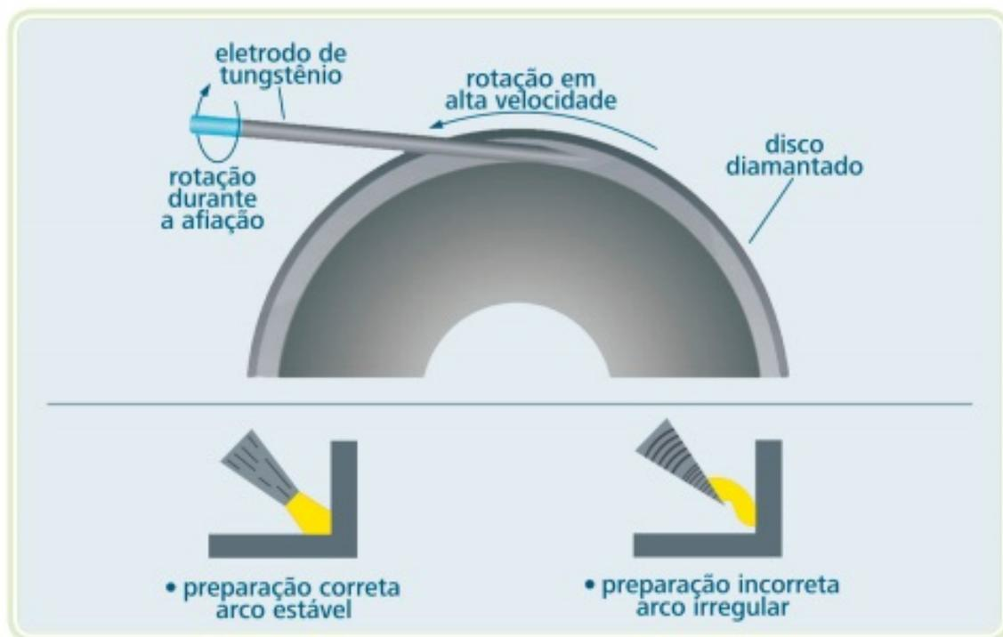
Figura 2.13: Importância de uma correta preparação da ponta do eletrodo (Peixoto [2016])
