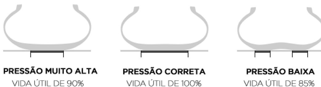
Figura 2.2 – Representação da banda de rolagem de acordo com a pressão. Fonte: Pirelli
