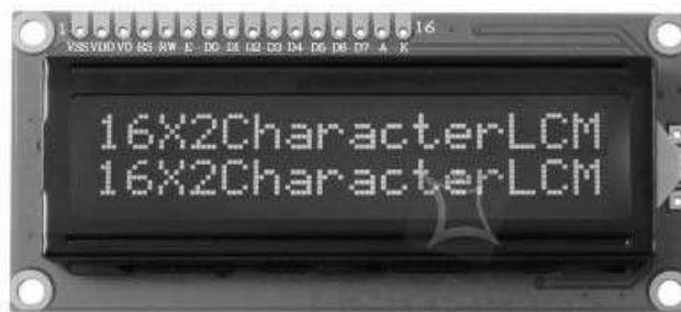
Figura 3.7 – Display 16x2. Fonte: UsinaInfo
