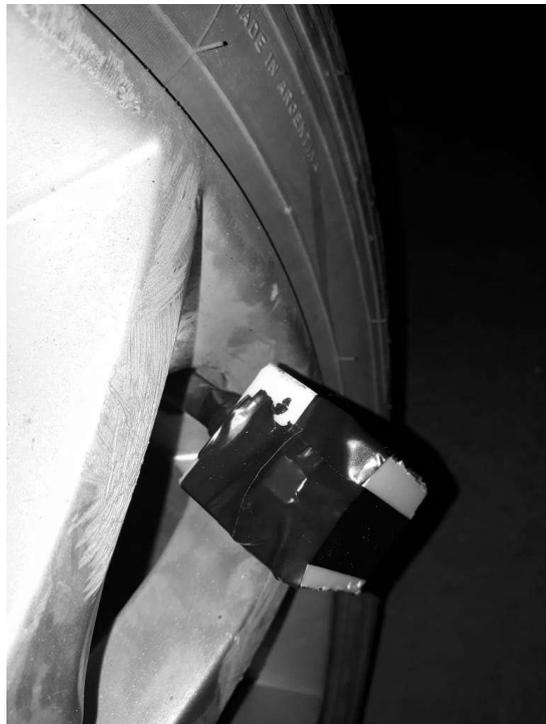
Figura 4.10 – Montagem do sensor na válvula.
