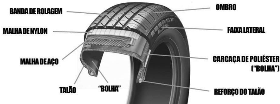
Figura 2.1 – Estrutura do pneu. Fonte: Guia de compra
