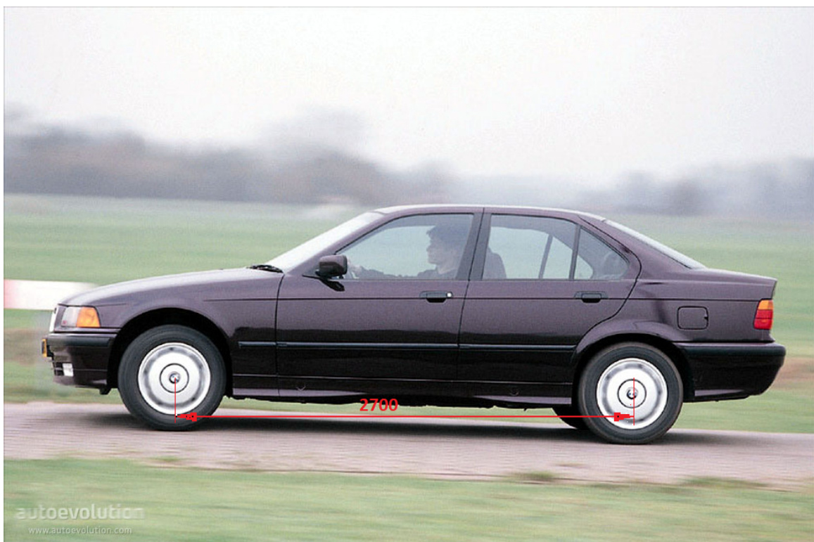
Figura 3.2: BMW série 3, E36. Dimensão entre eixos. [18]
