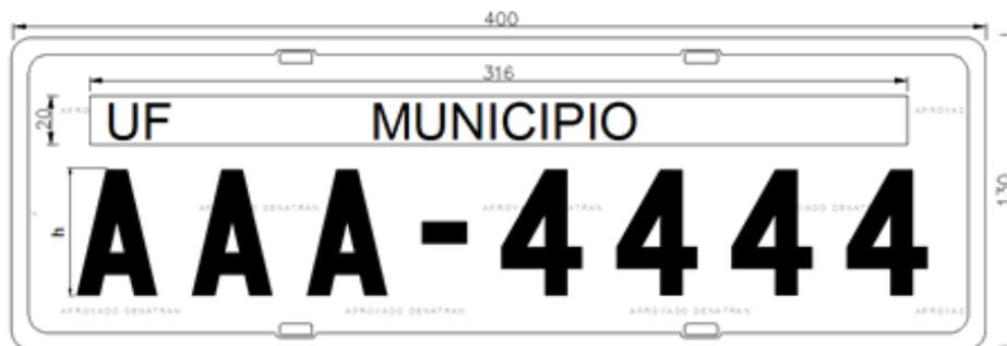
Figura 8 – Dimensões da Placa de identificação
