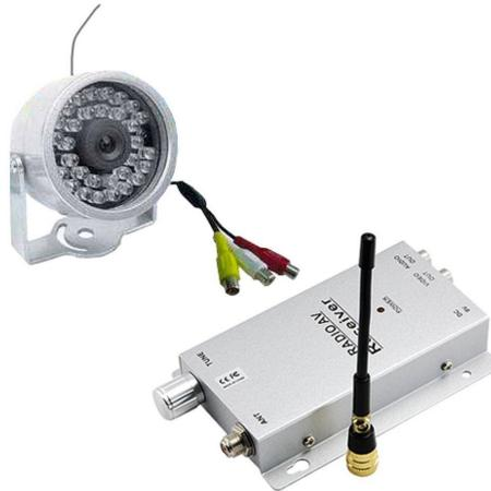
Figura 11 – Câmera de transmissão sem fio com infravermelho.
