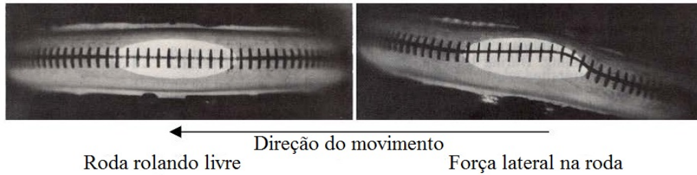
Figura 2.7: Comparativo da roda em rolamento livre e sob ação de uma força lateral. Fonte: Clark 1981
