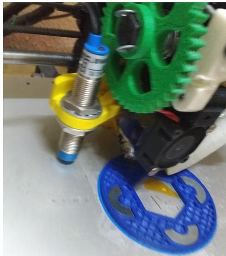
Figura 3.13: Posicionamento da parte metálica durante a etapa de impressão da peça auxiliar.
