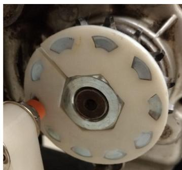
Figura 3.16: Peça auxiliar para medição da velocidade na saída do motor com 10 pontos metálicos.
