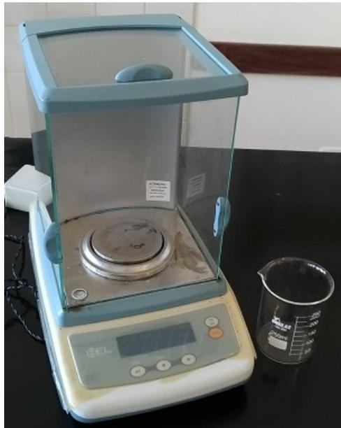
Figura 3.21: Balança de precisão e béquer utilizados para medição da massa de combustível entregue.
