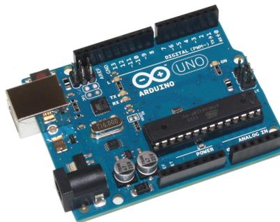
Figura 2.6: Placa Arduino Uno.
