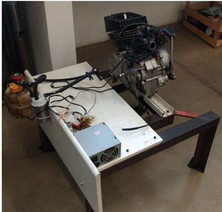
Figura 3.1: Planta inicial do motor de combustão interna de dois tempos.
