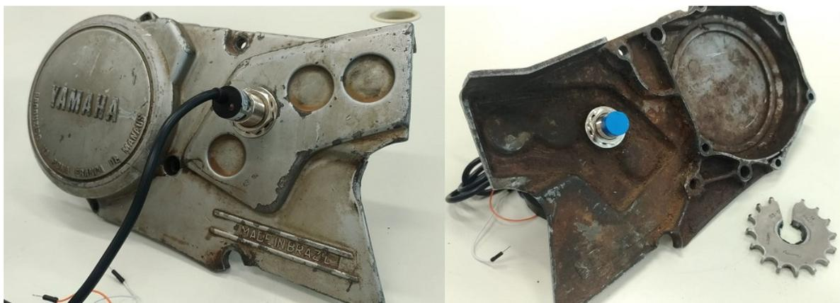
Figura 3.2: Posicionamento do sensor indutivo e engrenagem com rasgo para medida da rotação.
