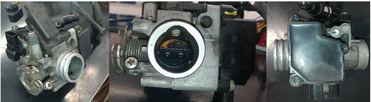
Figura 3.19: Corpo de injeção eletrônica completo (Honda CG 150).
