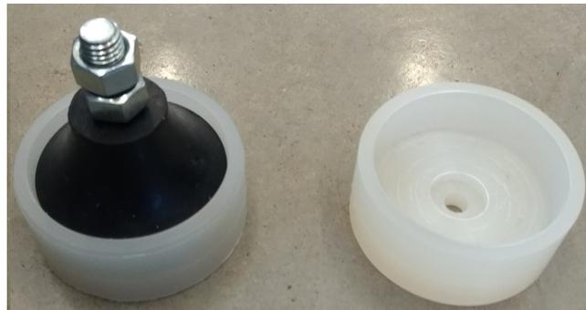
Figura 3.8: Apoio do vibra-stop usinado em Náilon.
