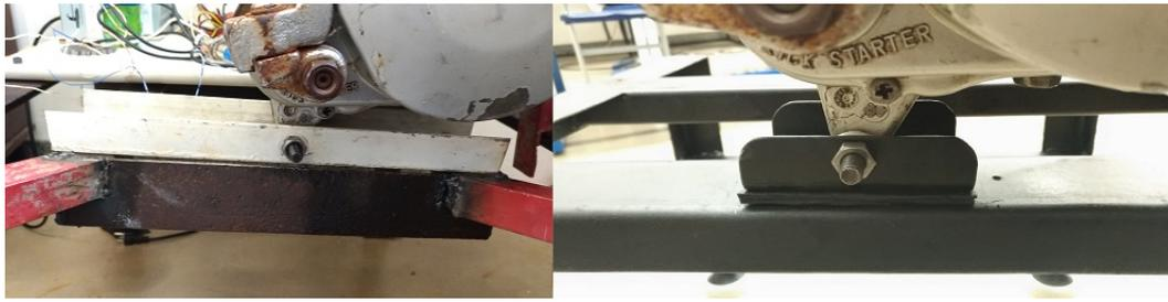
Figura 3.9: Modificação dos apoios do motor.
