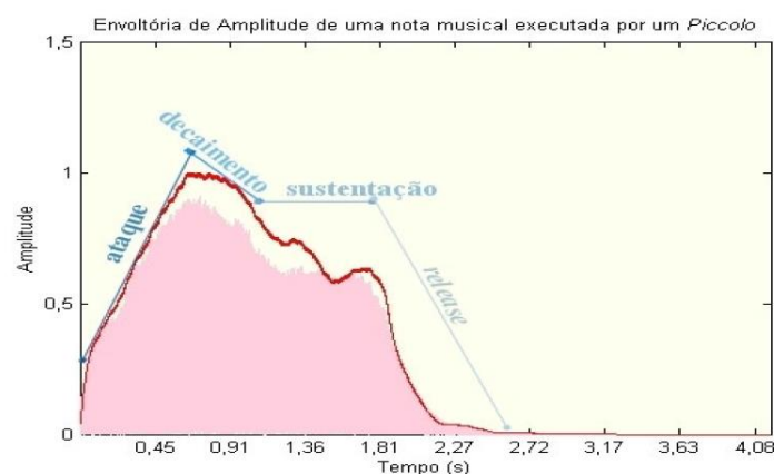
Figura 2.16: ETAPAS DE UMA ONDA SONORA EMITIDA POR UM INSTRUMENTO AO LONGO DO TEMPO.
